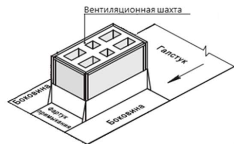
Схема установки деталей фартука
